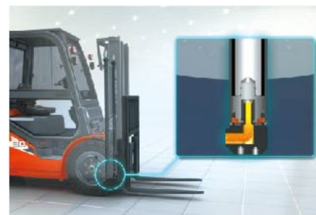
■ dispositif d'amortissement de l'abaissement
